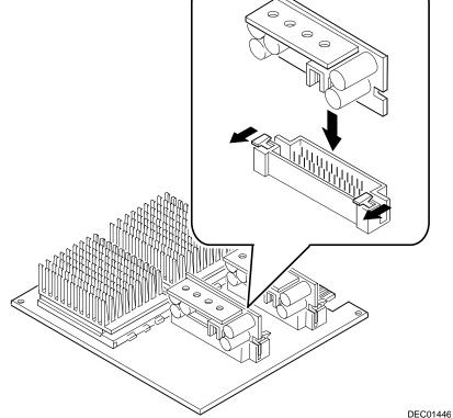
Figure 5-9. Installing a VRM
